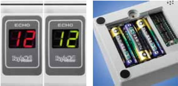
受信機に信号が届くとLEDの表示が赤から緑に変化します。
