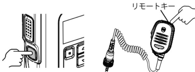
登録すると、キーを短く押す、長く押すことによって設定された機能が動作します。
