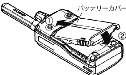
2 バッテリーカバーを無線機裏面の溝に合わせて取り付けます
