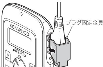
金具の左にある爪をスピーカー / マイクロホン端子部分の溝に合わせます。
