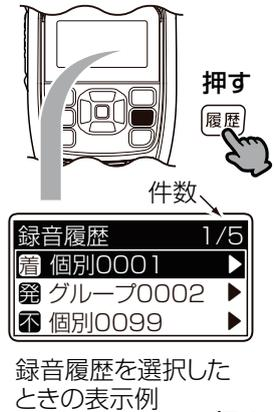
② 録音履歴が2件以上の場合は、**【▲】/【▼】**スイッチを押して選択します。
