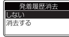
記憶された発信履歴、および着信履歴を消去します。
