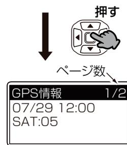
測位日時と追尾衛星数(SAT)の表示例
