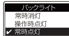
送信以外の操作をすると、表示部とスイッチの照明を自動点灯させるかさせないかを設定します。
