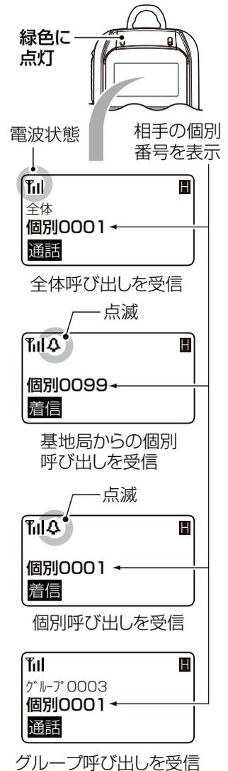
※ほかに通話している無線局(同じ通話チャンネルで、ユーザーコードが異なる誰かが通話中)の電波を受信しているときも、【送・受】ランプが緑色に点灯し、電波状態を表示します。
