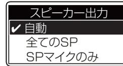
外部スピーカーを接続したとき、マイクロホン(HM-206、HM-204)から受信音を出力するかしないかを設定します。
