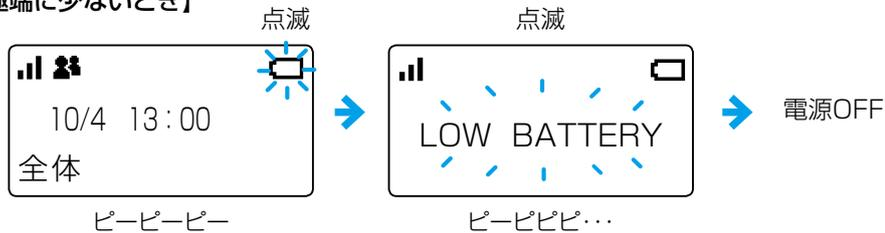
※残量表示が「
