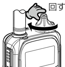
※防塵/防水対応により、簡単に回らない構造になっています。
