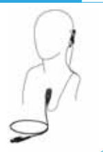
EK-313-581 小型タイピンマイク&イヤホン イヤホンは脱落防止の耳かけ式
