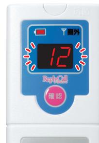
⚠【ご注意】記録した呼び出し履歴は、受信機を充電器にセットした時に消去されます。
