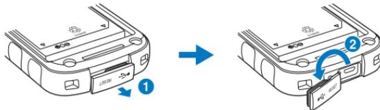
**5 電池カバーの凸部と本体下部の溝を合わせて、電池カバーを閉じる**
