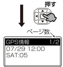
測位日時と追尾衛星数(SAT)の表示例
