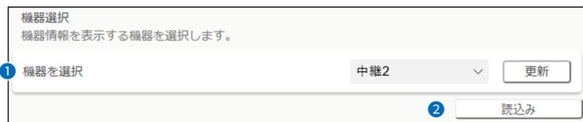
**① 機器を選択** ..... LTE回線で連結した連結先本製品の電池残量やLTE電波レベルなどの機器情報を遠隔地から確認する場合、「機器情報」画面に読み込みたい連結先本製品の本体名称(例：中継2)を選択します。
