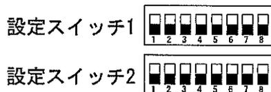
**メモ** リモコンによる遠隔操作をおこなったあとに、スイッチ操作によるチャンネル変更をおこなうこともできます。その場合はスイッチによる設定内容が優先されます。改めてリモコン操作をおこなうには、設定スイッチをすべて OFF 側に戻してください。
