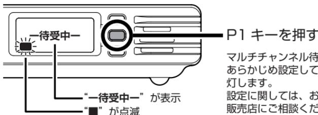
2. 信号を受信した時は、受信したチャンネルで待ち受けが止まり相手の話を聞くことができます。その後 [P1] キーが点滅している間にマイクロホンの PTT スイッチを押すと送信することができます。
