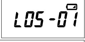
**メモ** 「電源が入らない」「オンオフを繰り返す」「ディスプレイ表示が消える」「ハウリング」などの症状が出た場合も電池の消耗を考えられるため、新しい電池と交換してください。
