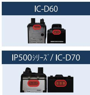
輸送時の振動などが原因で接点部分にズレが生じ
