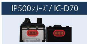
輸送時の振動などが原因で接点部分にズレが生じ電源が立ち上がらない場合がございます。
